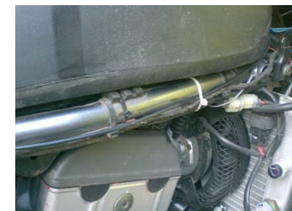
Strippen ziehen: Ein Kabel muss zum Display am Lenker.
