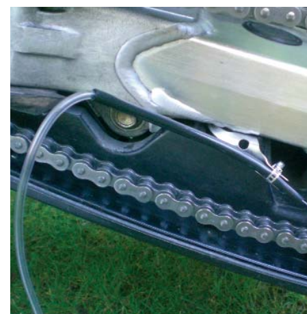
Injektion: Montage der Tropfdüse an der Kette.
