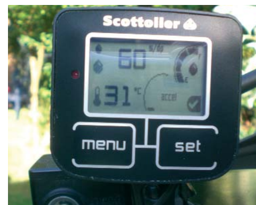
Ölbörse: Am Display lassen sich allerlei Infos abrufen und die Ölmenge steuern.
