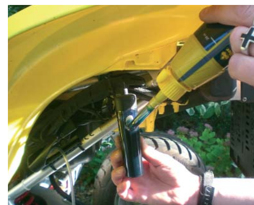
Füllung: Das Ölreservoir muss ab und an nachgefüllt werden.
